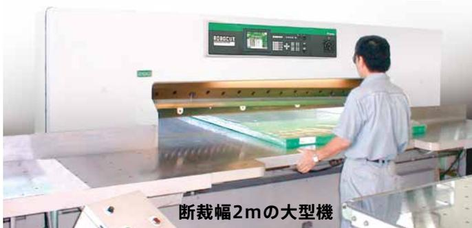
断裁幅2mの大型機
